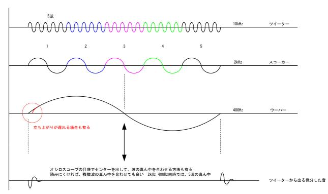
上の400Hzを入力し、チャンネルデバイダーの HighだけをON 他はOFFにすると、波の前後に微分波形が音として出る 複数波の場合でも、波の始めと終わりの2箇所だけに出る 所在が判ったら、それが目印となる
